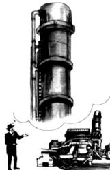
炼制1t生铁所需焦炭的实际用量远高于按照化学方程式计算所需的量，且从高炉中出来的气体中含有未利用的 $\text{CO}$ 气体。开始时，炼铁工程师们认为是 $\text{CO}$ 与铁矿石接触不充分的原因，于是设法增加高炉的高度。然而，令人吃惊的是，高炉增高后，高炉尾气中 $\text{CO}$ 的比例竟然没有改变。这成了炼铁技术中的科学悬念。
